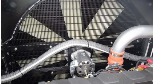
Ventola di raffreddamento reversibile a comando idraulico
