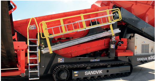
Pedane di manutenzione a ripiegamento idraulico.
