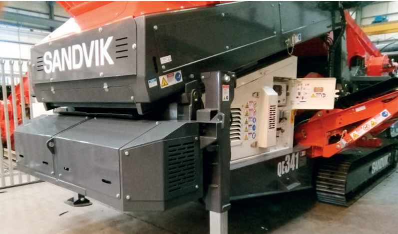
Azionamento ibrido opzionale per il collegamento alla rete elettrica.
