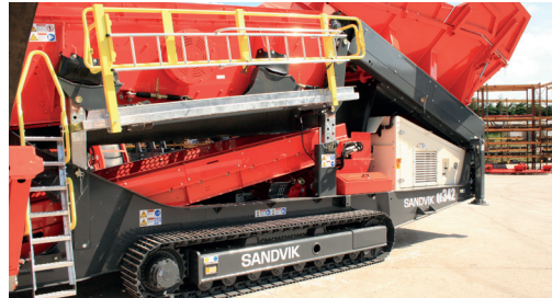
La struttura di sollevamento della cassa vibrante consente un accesso facile.
