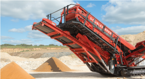
Passerella con ripiegamento su tre lati in prossimità del nastro principale
