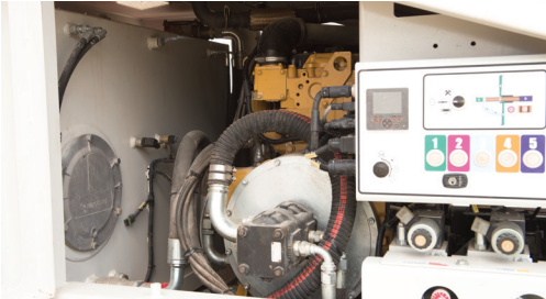
Impianto idraulico ad elevata efficienza e giri/min ridotti per un basso consumo di carburante
