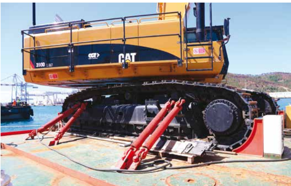
IL RIZZAGGIO DELL'ESCAVATORE È STATO REALIZZATO MEDIANTE TORNICHETTI E L'INSTALLAZIONE DI QUATTRO TACCHE SU CUI VIENE DIRETTAMENTE SALDATO IL CARRO
