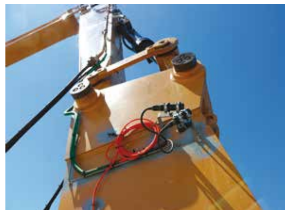
PER INDIVIDUARE IL PUNTO MIGLIORE DOVE ATTACCARE I PLINTI DA DEMOLIRE SONO STATE INSTALLATE DELLE SPECIFICHE TELECAMERE SUL BRACCIO DELL'ESCAVATORE CAT 390DL
