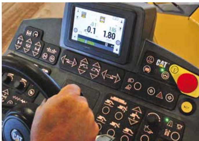
4. Il sistema CAT Grade Control per la massima precisione di stesa
