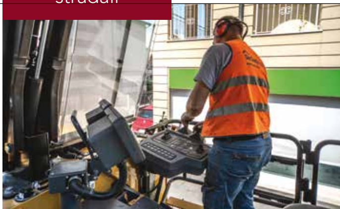
4. I comandi regolabili in altezza forniscono immagini per il controllo e la diagnostica della macchina
