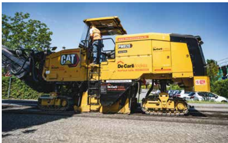
3. Il sistema Grade Control consente la verifica in continuo, il taglio e la precisa profondità di scavo
