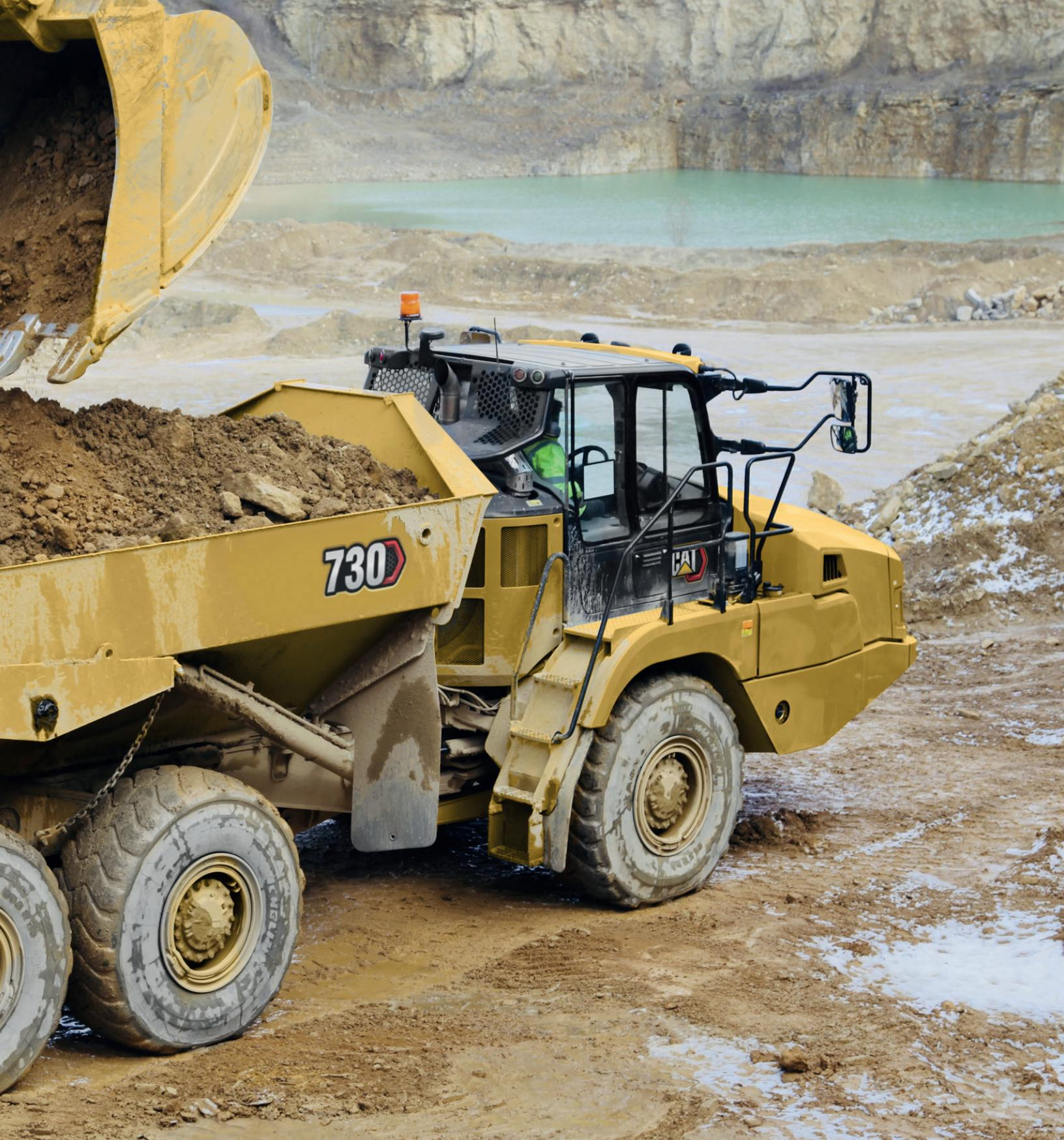
Il Cat 730, con una capacità di 17,5 m<sup>3</sup>/28 tonnellate metriche mostra doti di affidabilità, resistenza, alte prestazioni e produttività provate sul campo nonché la massima comodità in cabina per migliorare il comfort dell'operatore e la facilità di utilizzo.
